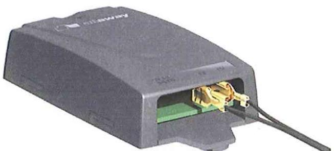
Montera skräpluckans startanordning och se till att antennen är rak. Anslut startanordningens lågspänningsledningar till skräpluckans ledningar. Mer detaljerade instruktioner om hur skräpluckans startanordning används finns i bruksanvisningen för skräplucken.
